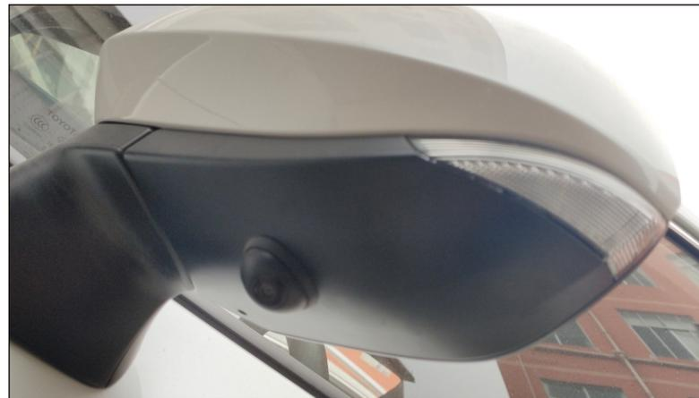
左视安装支持通用打孔和配专用左视安装，注意通用打孔时打合适的安装位置不要挡镜片和太近车身位置
