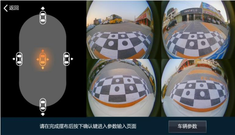
进入拼接画面把左右摄像头旋转车身朝下平行,然后把摄像头压平安安装硅胶位置,前后摄像头观看图像有没有反或显示不良情况。
