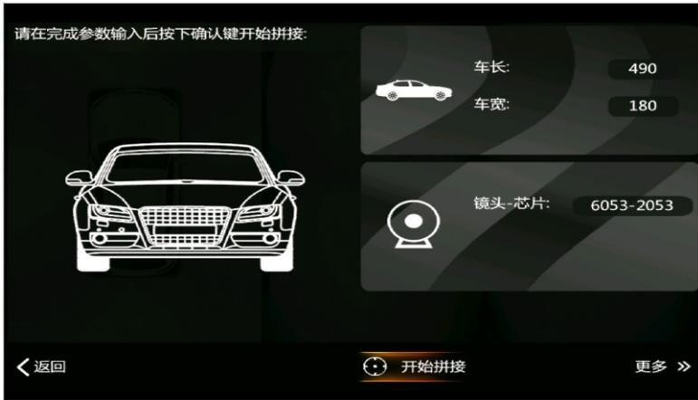
选用长4.4米黑格拼接布要把车长:输入:量车长前布与后距离有多长,车宽:车身宽度,镜头和芯片选择对应安装摄像头参数,按开始拼接约5秒内完成拼接成功提示.
