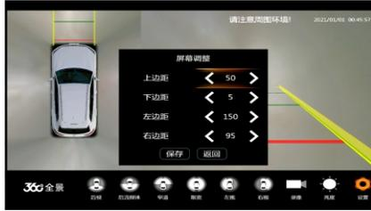
调整上下左右显示边框输入根据实际差异调整数值。
