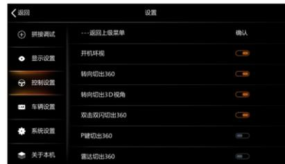
可以打开开机环视和关闭; 转向打开关闭; 切换转向3D视角打开; 切换2D关闭3D视角; 双击双闪开关打开和关闭; P键切出360; 雷达切出360加解码器或装双CAN机原车有此功能可以选择打开此功能。
