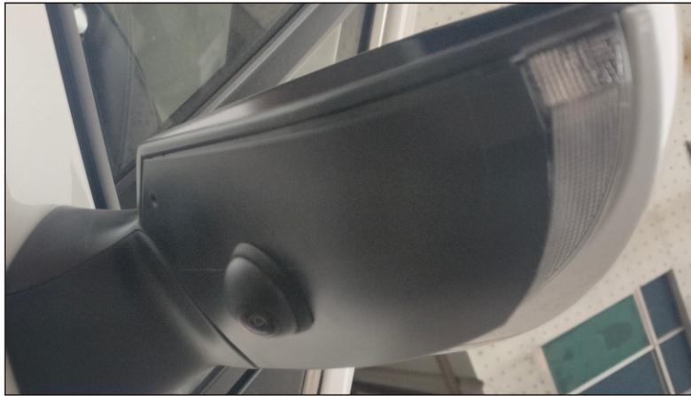
右视安装支持通用打孔和配专用右视安装，注意通用打孔时打合适的安装位置不要挡镜片和太近车身位置。
