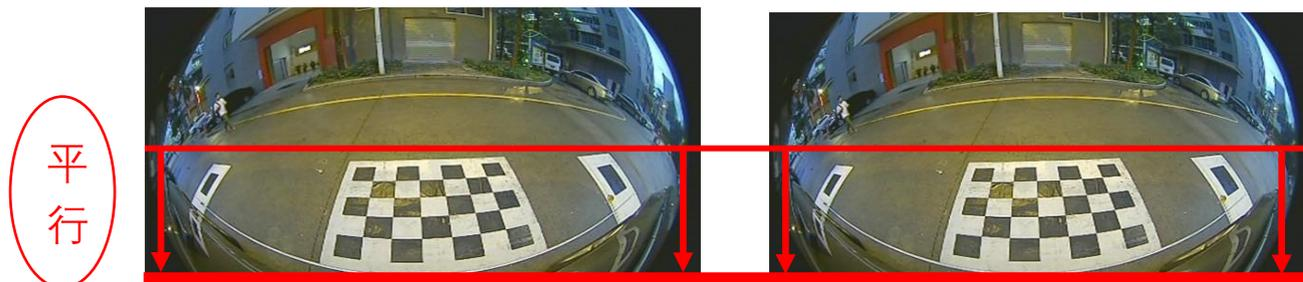
3. 前、后标定布必须和车头平行(尺卷数据仅供参考, 实际参数需要测量); 且标定布正中间必须在车辆正中间;
