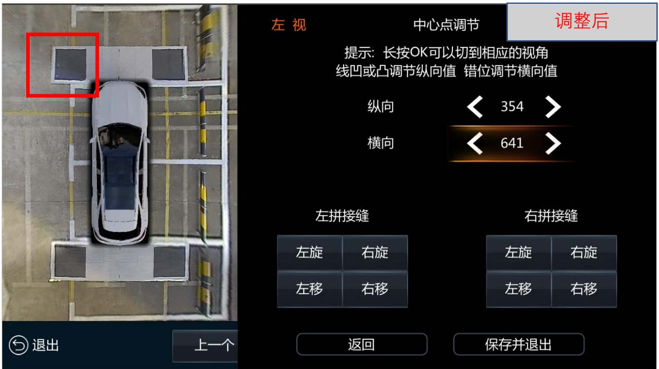
4. 喇叭式：当拼接缝前视或后视出现像喇叭式歪曲，可通过“左拼接缝或右拼接缝的左旋或右旋”进行调整；
