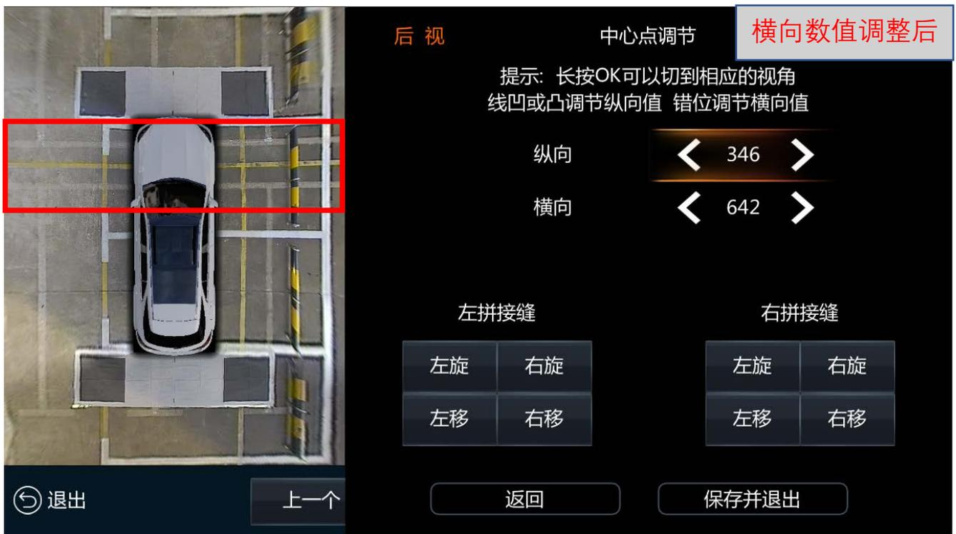
3. 错缝：当左前、右前、左后、右后、拼接缝有错位时，可以通过“左拼接缝和右拼接缝中的左移和右移进行调节；(如图)左前有错缝，通过左拼接缝的右移进行调节；
