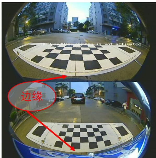
2. 摄像头安装时图像应与车身平行, 以刚看到车身为基准; 左右摄像头安装角度尽量保持一致; 左、右摄像头需看到前后标定布黑色方块; 左右标定布也可不用, 或用来做参考; (如图)
