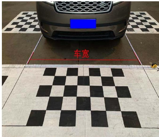
5. 精准数据测量:车高、轴距、前轮距、后悬等参数测量; (如图)
